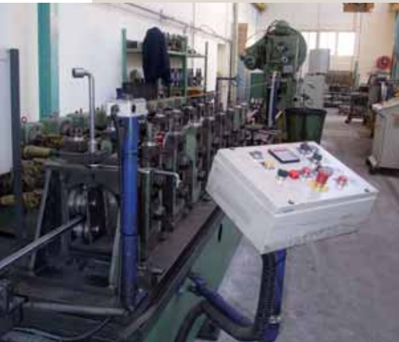
A partir de bobines d'acier, deux lignes de profilage à froid découpent à la longueur souhaitée (entre 1 m et 2,5 m) les crémaillères qui subiront différents usinages avant d'avoir leur forme définitive. La vitesse de défilement de la bobine sur ces lignes peut atteindre 30 m/min.
