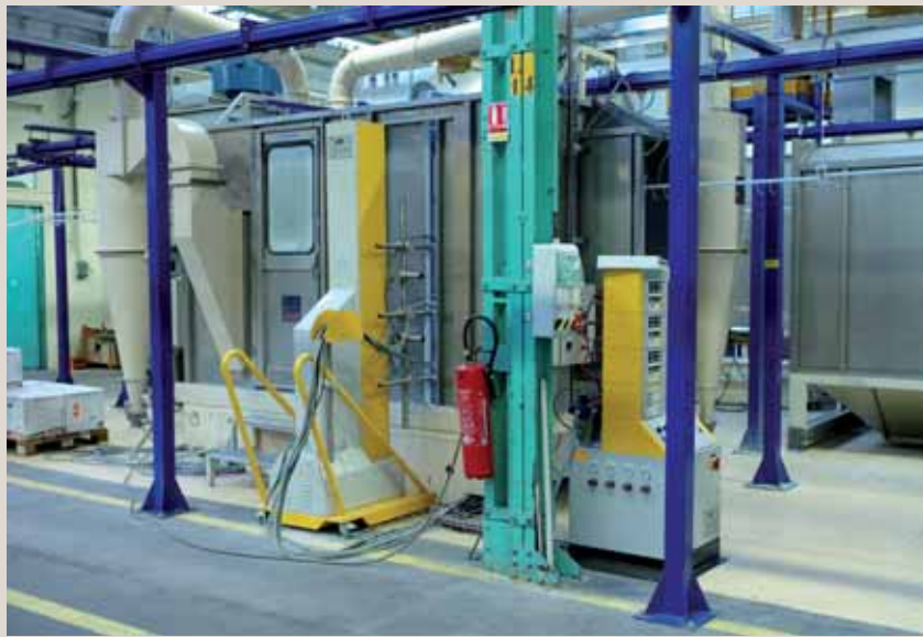
Après avoir été séchées dans une étuve et avant d'être cuites, les pièces sont peintes dans deux cabines de peinture, une automatique et une manuelle utilisée pour les petites séries et certaines couleurs. Les crémaillères et consoles (de couleur blanche pour 70% d'entre elles) sont ensuite emballées et étiquetées.
