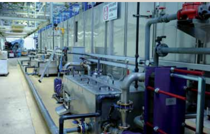
Avant d'être revêtues d'une peinture époxy en poudre, les consoles et crémaillères fortes passent dans un Tunnel de Traitement de Surface d'une longueur d'une trentaine de mètres d'où les pièces sortent lavées, dégraissées et phosphatées.
