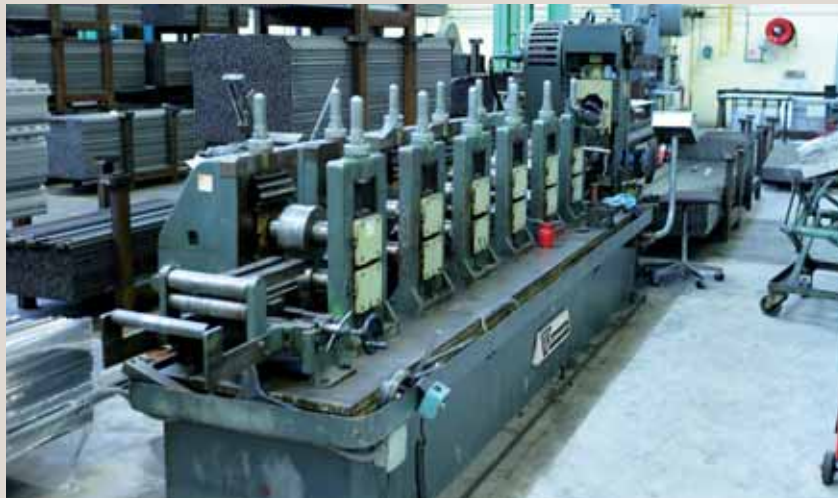
Cette profileuse de capacité importante peut traiter les bobines d'acier de forte épaisseur (jusqu'à 5 mm) pour la réalisation de profilés lourds.
